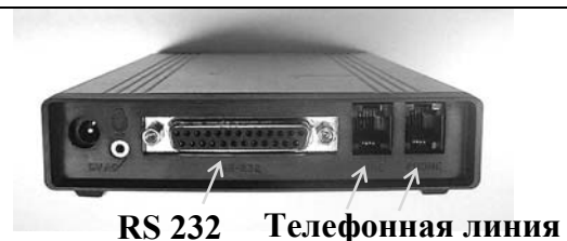
Рисунок 4.5. Разъемы для подключения последовательного порта на металлодетекторе.
