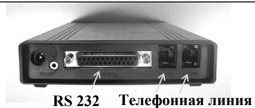
Рисунок 4.5. Разъемы для подключения последовательного порта на металлодетекторе.
