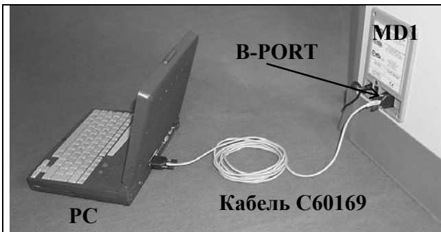
Рисунок 4.4а. Подключение металлодетектора (MD1) к компьютеру.
