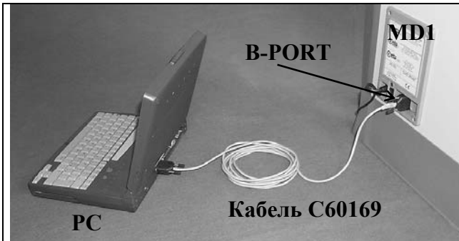
Рисунок 4.4а. Подключение металлодетектора (MD1) к компьютеру.
