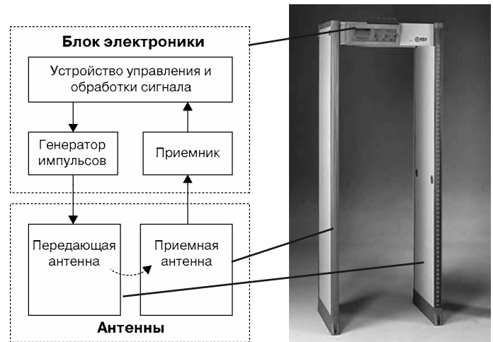
Рисунок 1.1. Структурная схема металлодетектора
